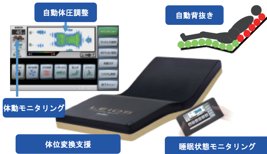
世界初体圧センサ搭載 ロボティックマットレス LEIOS (2016) 図19 ロボティックマットレス LEIOS
